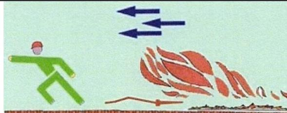
Operare ad una distanza di sicurezza compatibile con la lunghezza del getto dell'idrante
